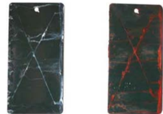
Chapa izquierda: zinP 1.200 horas CNS Chapa derecha: pintura sobre acero 220 horas CNS
